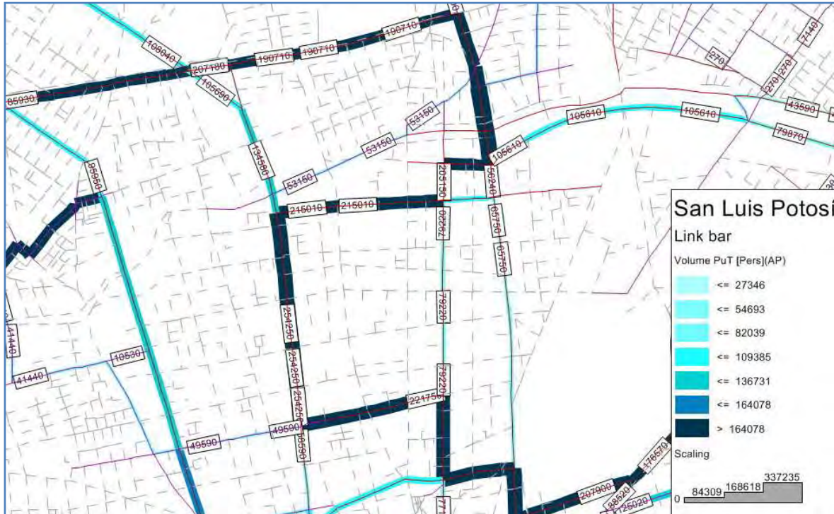
Figura 29 Detalle de carga de pasaje por tramo vial posible en el Centro (pas/día)
